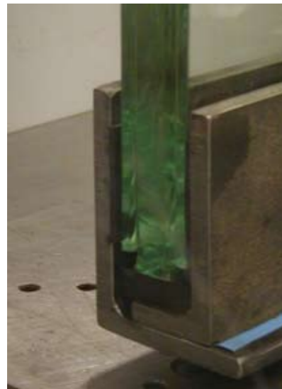
图例10 铁槽详图 Figure 10 Shoe Detail
